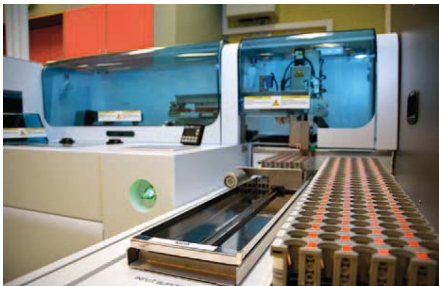
Robotten som modtager blodprøverne fra rørsystemet og sender dem videre til analyse i laboratoriet. Foto: Thomas Wittrup
