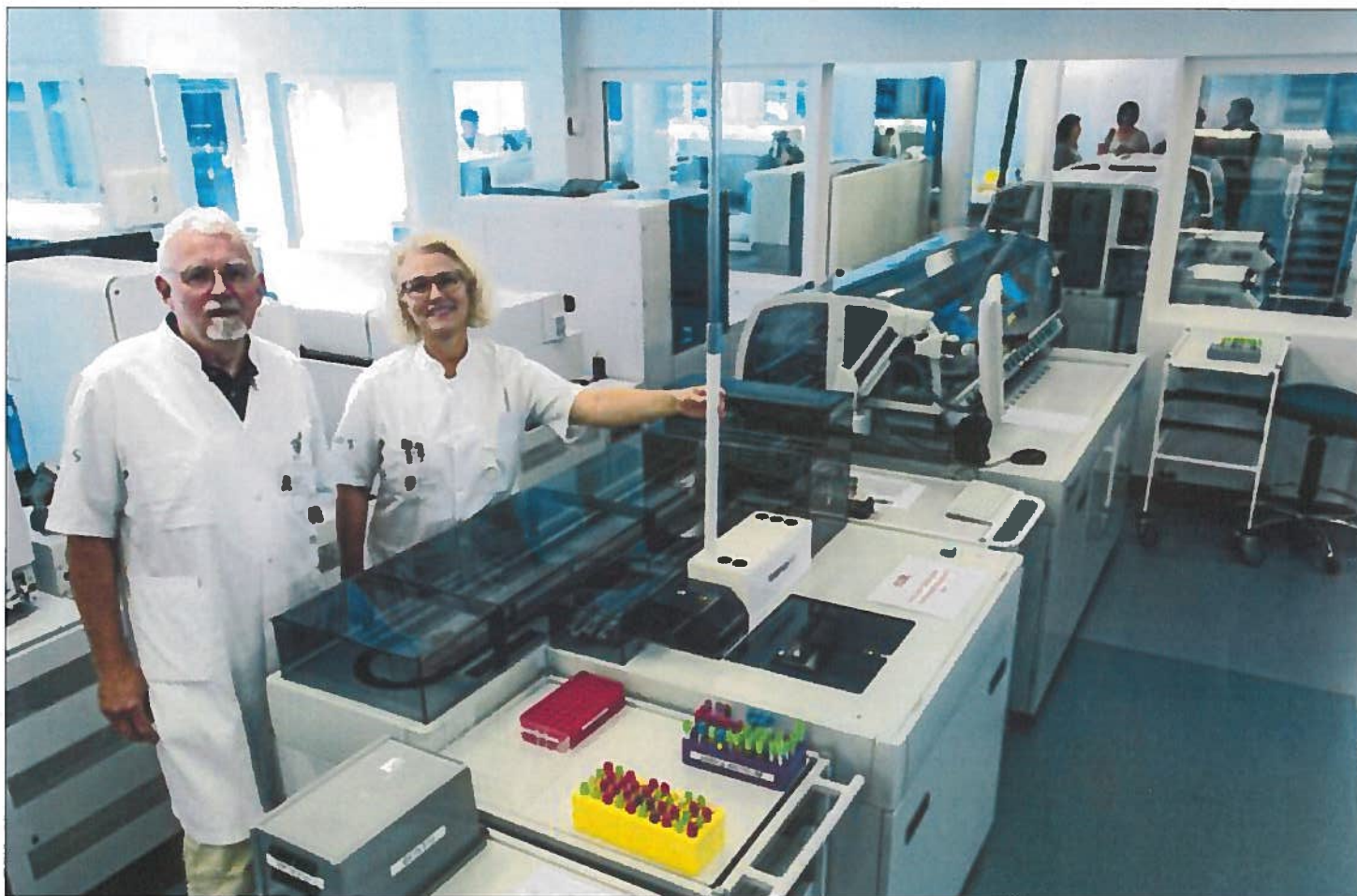
Ledende overbioanalytiker Anne Haahr Ibsen og ledende overlæge Poul Bjerrum ved rørpusten. Prøverne skydes af med trykluft nedefra og falder det sidste stykke med tyngdekraften for at lande blødt.
